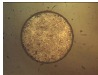
5. att. Al maska 0,4 μm pēc kodināšanas SiO 2 5 μm.
