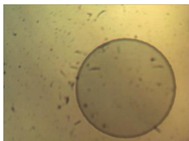
3. att. SiO 2 kodināšanas paraugs 5 μm biezs (šķidrums tralēšana) ar Al masku 1 μm biežumā. Maska noņemta.
