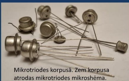
Mikrotriode ir radioelektronikas elements ar trim "kājiņām", ko izmanto elektriskās strāvas pastiprināšanai.
