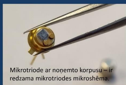
Mikrotriodes korpusā. Zem korpusa atrodas mikrotriodes mikroshēma.
